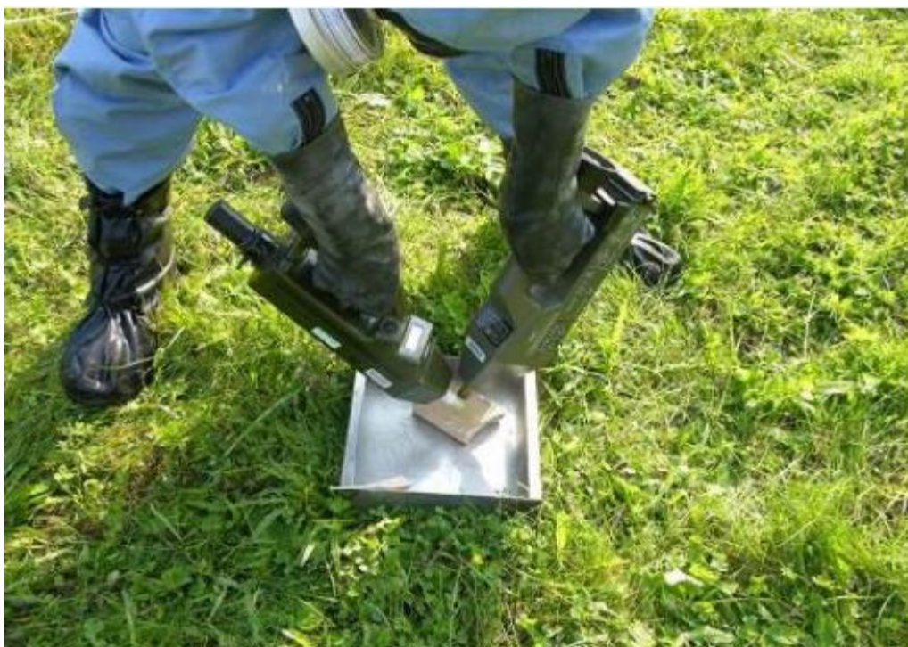
شکل 2.2: تصویری از بازرس OPCW هنگام آموزش در جمهوری چک که در حال استفاده از دو آشکارساز با تکنولوژی‌های مختلف
